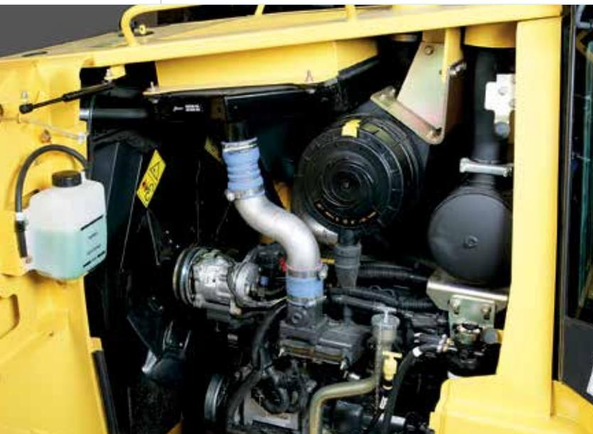
O novo motor New Holland Common-Rail, de alta tecnologia, foi projetado para desenvolver potência e torque elevados e proporcionar uma redução no consumo de combustível e na emissão de poluentes. Gera uma potência máxima 12% maior, com a mesma rotação do virabrequim (2.200 rpm), e um aumento do torque máximo para 690 Nm (comparado com 60 Nm do modelo anterior).
