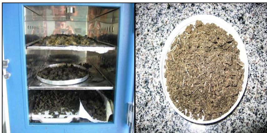
Figura 4. Secagem do resíduo em estufa com circulação de ar, a 55°C, por 72 h.
