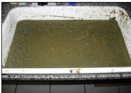
Figura 3. Resíduo úmido de batata-doce após processos de trituração, sacarificação, fermentação alcoólica e destilação.
